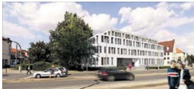
In Anlehnung an die umliegende Bebauung der 1930er- und 50er-Jahre erhält der Neubau eine Lochfassade. Alle Fenster können von Hand geöffnet werden und sorgen für natürliche Belüftung. Das Wechselspiel von schmalen und breiteren Fensterelementen soll den strengen Rhythmus auflockern. Als Reminiszenz an die Tradition der optischen Industrie werden die schmalen Gläser getönt. Visualisierung: BHS5 Architekten GmbH Leipzig
