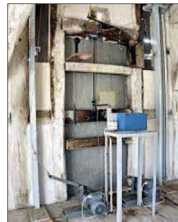
So banal kann ein Jenaer Wunder aussehen: Der Antrieb für die Rathausuhr und den Schnapphanskopf.
