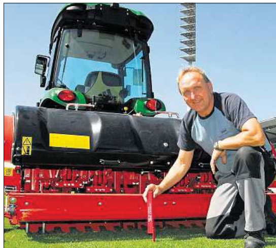
Der Zollstock-Beweis: Das neue Tiefenlockerungsgerät kann bis zu 250 Millimeter tiefe Luftlöcher in den Rasen des Ernst-Abbe-Stadions stechen. – Ein wichtiges Rasenpflege-Element zur Aktivierung des Bodenlebens, wie Chef-Platzwart Frank Kühn gestern erläuterte. Foto: Thomas Stridde
